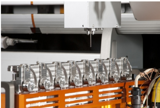
图2:OSR气压控制取样端口
